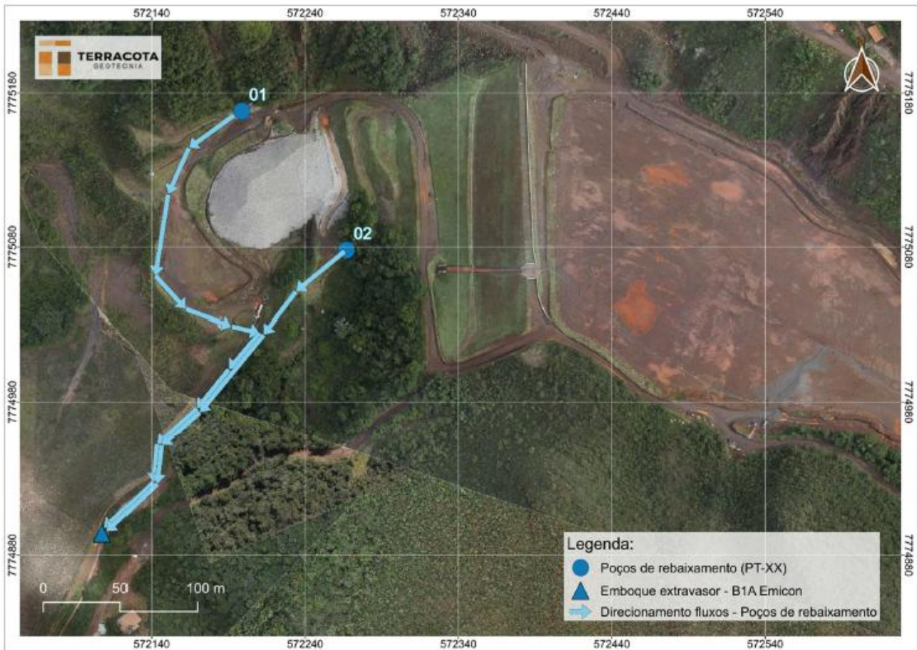
Figura 5.9 – Localização e direcionamento do fluxo dos poços de bombeamento - Barragem B1 – Mina Ipê.
